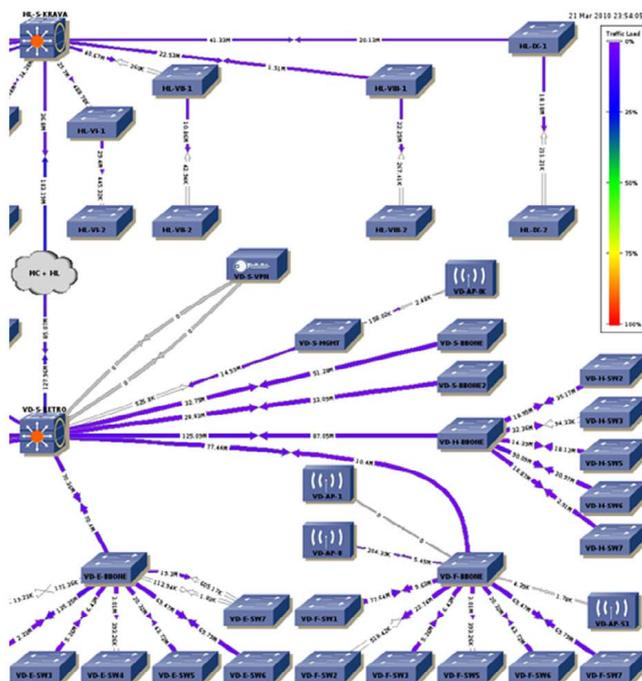
Bol spustený grafický monitoring zataženia chrbticovej siete v reálnom čase. Tento prehľad nám umožňuje pružne a včas reagovať na vzniknuté nepriaznivé situácie 24 hodín denne, 7 dní v týždni.
